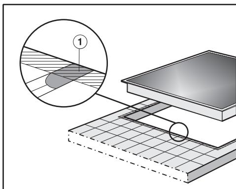
Fuge ① i crtkana područja ispod ruba za brtvljenje na ploči za kuhanje moraju biti glatki i izravnati tako da ploča za kuhanje dobro leži i da brtva ispod ruba uređaja osigurava brtvljenje prema radnoj ploči.
