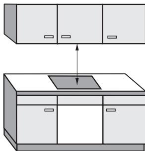
Između ploče za kuhanje i nape iznad mora se ostaviti razmak kojeg preporučuje proizvođač nape.
